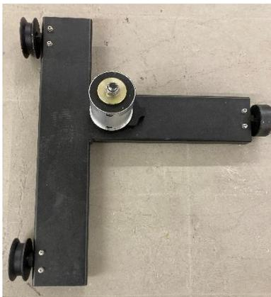
Abb.4: Fahrwerk Typ SR/DR
