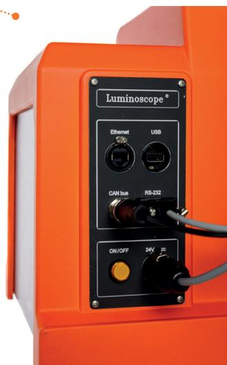
*Módulo estándar de placa de conexiones incluyendo interfaces USB, Ethernet y RS-232*
